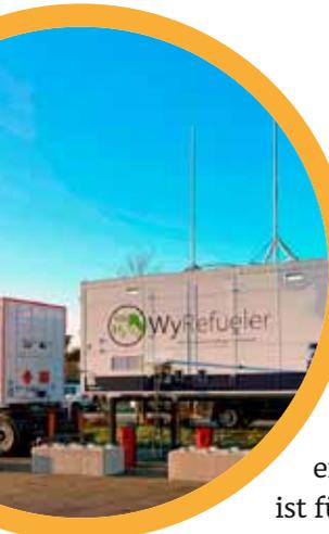
Bei der Ausschreibung zur Wasserstofftankstelle konnte das deutsche Unternehmen Wystrach sich den Zuschlag sichern. Die Tankstelle umfasst eine feste Tankstelleneinheit, die sich auf dem Betriebs- hof Bernau befinden wird und zwei mobile Tank- container in denen der Wasserstoff gespeichert wird. Das Gesamttankvolumen der Tankstelle entspricht ca. 1000 kg Wasserstoffstoff. Der Betankungsvorgang eines Fahrzeuges benötigt zwischen 10-15 Minuten und ist für 350-bar-Fahrzeuge ausgelegt.
